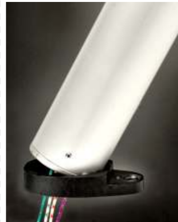
Mastefod, nyt design med mulighed for justering under dæk. Standard er stadig fod med 4 hjul.
